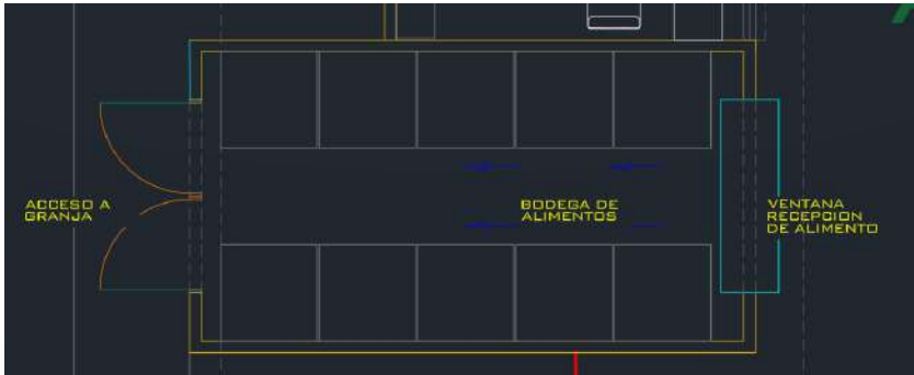
Imagen 27. Plano esquemático bodega de alimentos balanceados.
