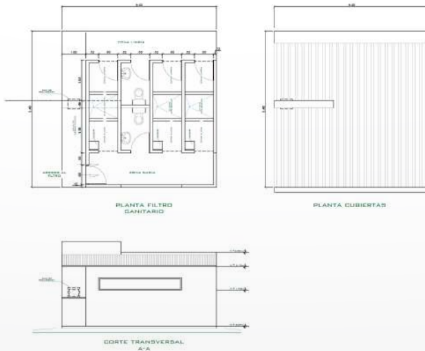
Imagen 35. Filtro sanitario triple.
