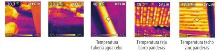
Figura 2. Medición de la temperatura de las instalaciones porcinas con cámara termográfica (Fuente: Blandón, H. 2019).
