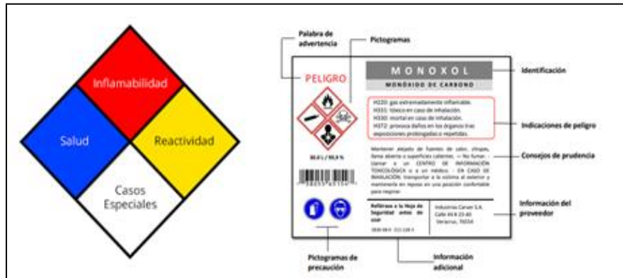
Imagen No. 5 Etiquetado sustancias peligrosas. Fuente: NFPA - National Fire Protection Association and MADS
