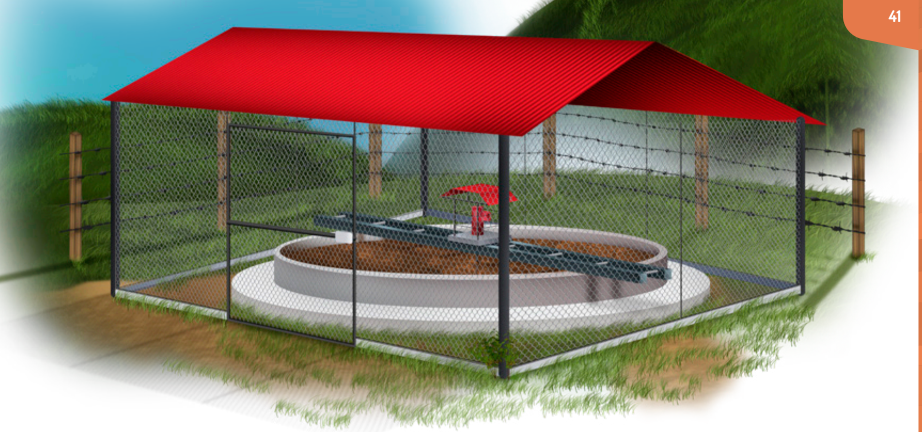
Ilustración 5. Tanques estercoleros en forma circular construidos en concreto
