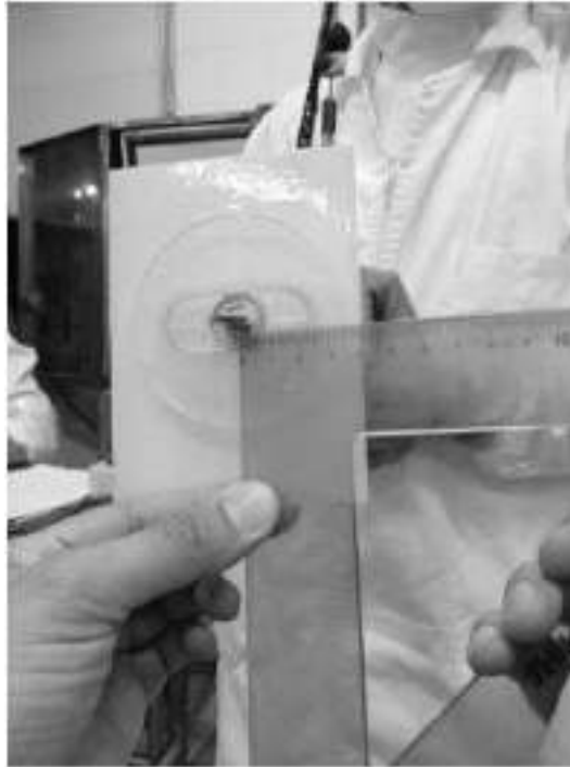
Guía de un equipo HGP-4 con medida inferior: 4 cm
