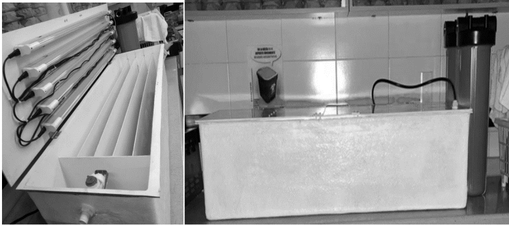
Figura 5. Interior equipo de desinfección UV.
